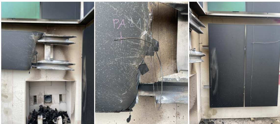
Abbildung 133: Schäden an der Fassade nach Brandversuch, Horizontales Modul (links und Mitte), Modul rechts der Brandkammer (rechts) ■
