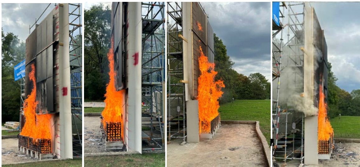
Abbildung 144: Brandeinwirkung auf das PV-Modul in der Primärflamme ■
