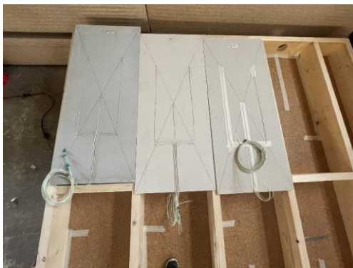
c) Führung der Thermoelemente je Gefach
